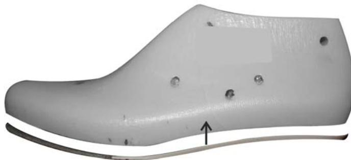
Conformación anatómica de ajuste de la plantilla de armado a la cara plantar de la horma
